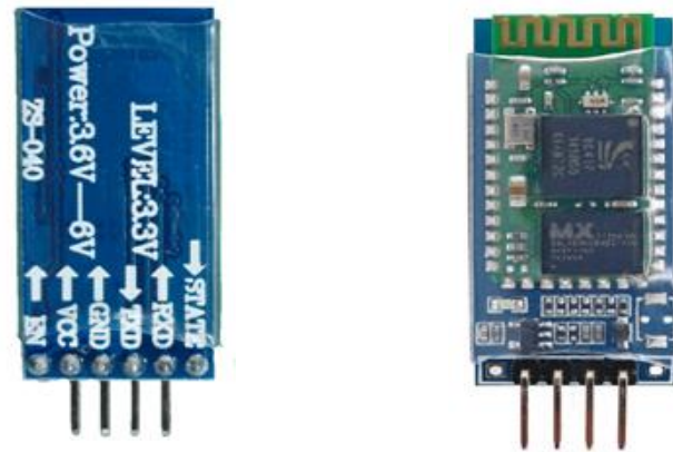
Fig 2.7: HC-06 Bluetooth Module
