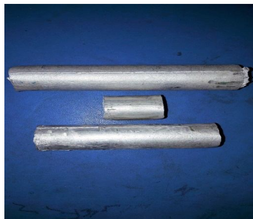
(d) Double shear strength test sample of Al+RHA+CDA+JSA
