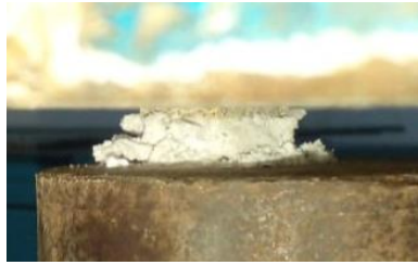
(d) Final failure
